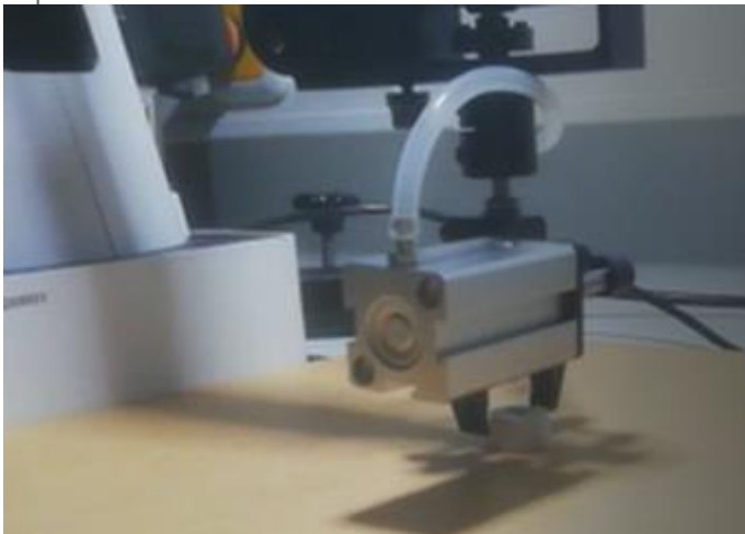
Abb. 1: DOBOT Magician Roboterarm in Aktion beim Greifen des „dreiseitigen Würfels“
